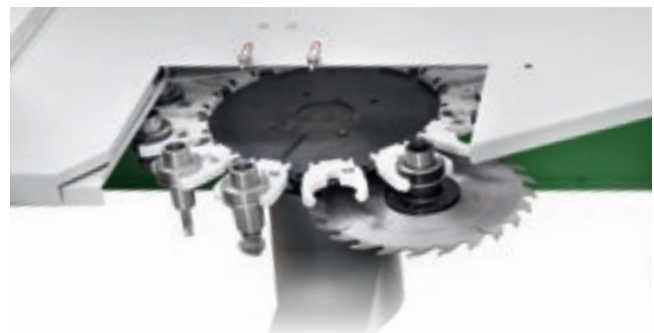
Revolver-Werkzeugmagazin mit 13/16 Plätzen.
