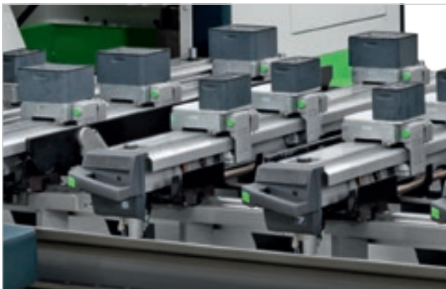
ATS (Advanced Table-Setting System) Ermöglicht eine einfache und schnelle manuelle Positionierung der Verriegelungssysteme.
