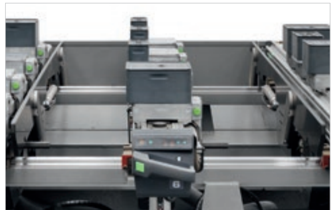
SA (Set Up Assistance) Ermöglicht eine einfache, schnelle und kontrollierte manuelle Positionierung der Verriegelungssysteme. Die im Arbeitstisch vorhandenen Linearsensoren und die Kollisionskontrollfunktion verringern die Kollisionsgefahr.
