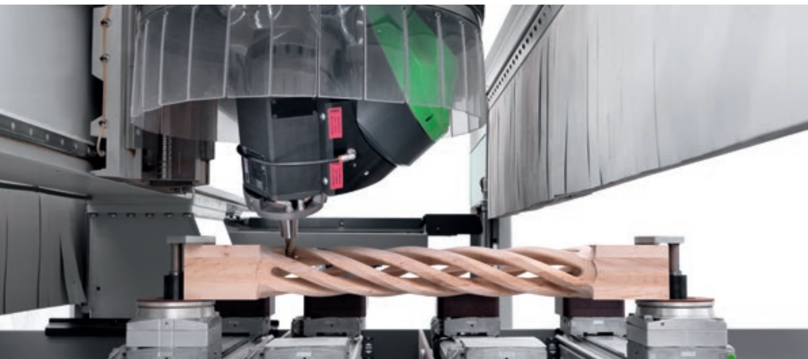
Einstellbare Absaughaube mit 19 Positionen.
